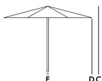
**Details Stamm:** Esche massiv und Naben Birke massiv, mehrlagig wasserfest verleimt, oberflächenimprägniert; **Streben:** Esche massiv, oberflächenimprägniert; **Edelstahlverbindungen;** Kernlederriemen; **Flaschenzugelemente** aus Messing bzw. Messing veredelt; **Bespannung:** Acryltuch
